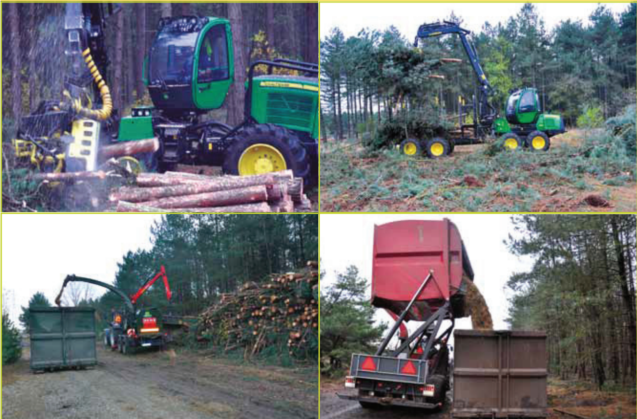
Figuur 1: Enkele van de ingezette machines aan het werk in Bosland. Van linksboven naar rechtsonder: De harvester ontdoet stamdelen van takken en de top en zaagt ze af op 3 meter. De forwarder rijdt toppen en takken uit tot aan de rand van de opstand. De hakselaar aan de kant van de weg hakselt de uitgevoerde toppen en takken en blaast ze in een container. De mobiele hakselaar leegt de houtsnippers uit het reservoir in een container.
